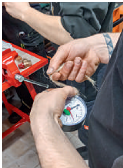
Etanchéité d'une valve avec du chanvre.
